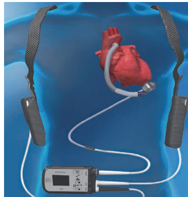
Schema implantiertes Pumpensystem inkl. Steuereinheit, Driveline und Akkus Fa. Abbott
